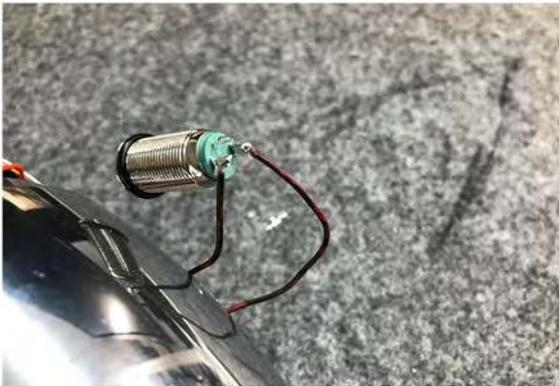
Die beiden Kabelenden (Minus) durch die Kontermutter des Schalters führen und anschließend durch das gebohrte Loch nach außen ziehen.
