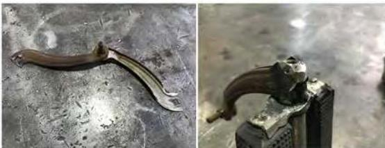
Je nach Bauart der Lampenhalterung muss diese mit einer Flex ein wenig gekürzt und in Form gebracht werden, um sie ohne störende Überstände durch Schweißen an dem Gewinde befestigen zu können.
