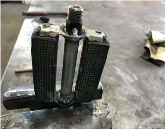
Um ein späteres Wegdrehen des oberen Lampenteils zu verhindern, wird zuerst das Pedal am Kugellager entfettet und mit einem Schweißpunkt fixiert.
