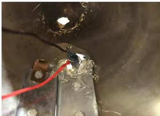
Den Micro- USB an einer unteren Öffnung so verkleben, dass von außen der Stecker in die Buchse gesteckt werden kann.
