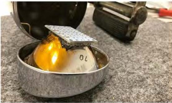
Wenn die Platine bündig hinein passt, mit Heißkleber fixieren. Darauf achten, dass die Plus- und Minuskontakte nicht verklebt werden.
