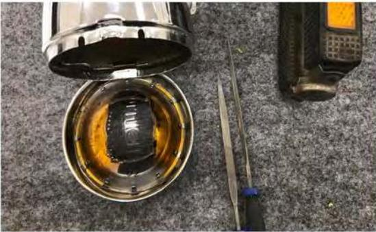
Den Lampenschirm so weit aussparen, bis die LED- Platine in die Öffnung passt.
